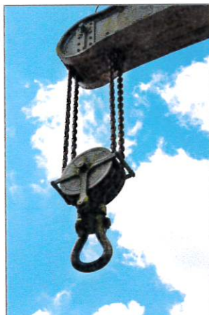
Det är lätt att lyfta den tunga lådan med en talja , men det går åt en hel del rep. Det man vinner i kraft, förlorar man i längd, vilket här betyder att det blir lättare att dra, men att det går åt mer rep.
