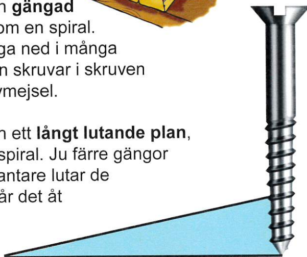
Skruren är ett långt lutande plan som vrider sig som en spiral.
