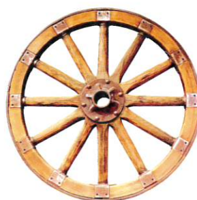
Hjul med ekrar . Ekrarna gör att hjulet blir lätt och behåller sin rätta form.
