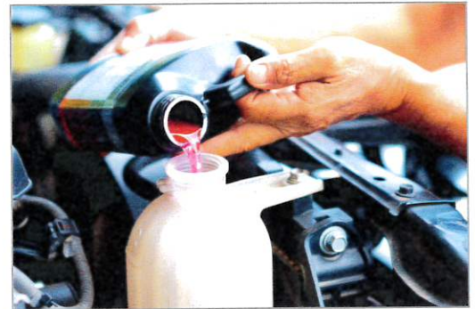
Påfyllning av kylarvätska. Eftersom många bilmotorer blir för varma av spillvärmen , måste motorerna kylas ner. Därför har bilar kylsystem.
