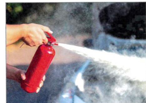
Koldioxidsläckaren innehåller flytande koldioxid under högt tryck. När man använder brandsläckaren kommer koldioxiden ut som kall kolsyresnö .
