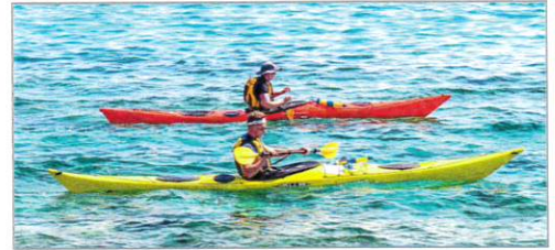
En kajak har ett långt och smalt skrov, för att minska friktionen mot vattnet.
