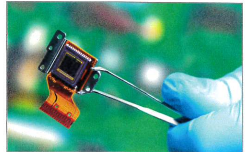
I digitala kameror är filmen ersatt av en CCD-detektor .
