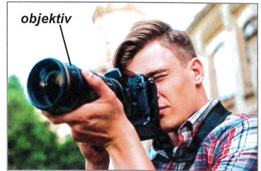
Längst fram på kameran finns ett objektiv , som oftast har flera linser i rad.
