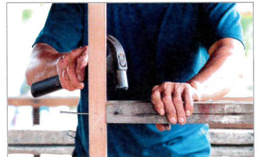
När en spik får den extra kraften från en hammare, blir trycket högt och den tränger lätt in i en träbit.
