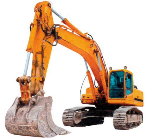
En grävskopa har breda band för att minska trycket mot marken.
