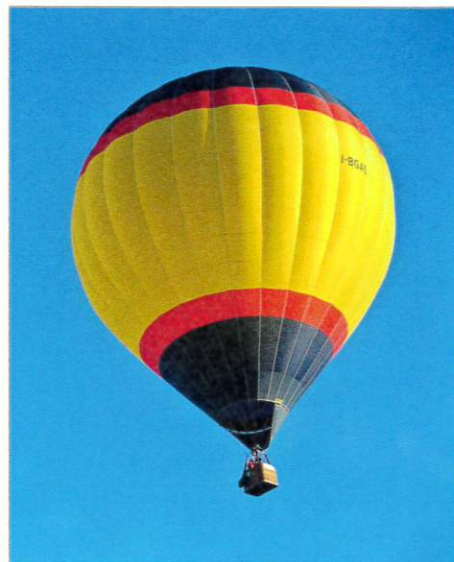
En varmluftsballong stiger, eftersom varm luft har lägre densitet än kall luft.
